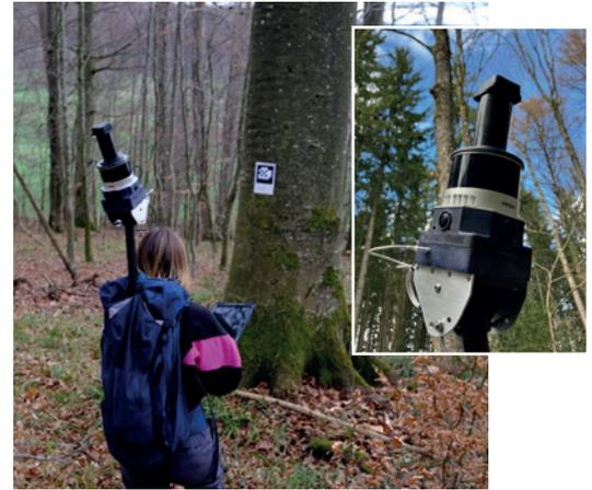
**Abb. 3:** Mobiler Laser Scanner. **Rechts:** der Sensor Oxford Frontier (selbstgebautes Gerät für online LiDAR SLAM). Bildquelle: Universität Oxford; **Oben:** der Sensor bei der Datenaufnahme in einem Wald im Kanton Schaffhausen. Bildquelle: Projer/WSL
